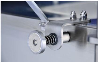
Aimant pour fixation de la porte dans tunnel de lavage à 270° et 260°
