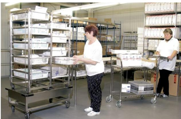
Casier de transfert sur le chariot de transfert dans le système AGV en préparation
