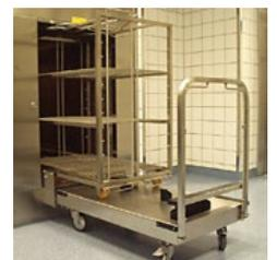
Charger un chariot intérieur à 2 voies dans l'autoclave
